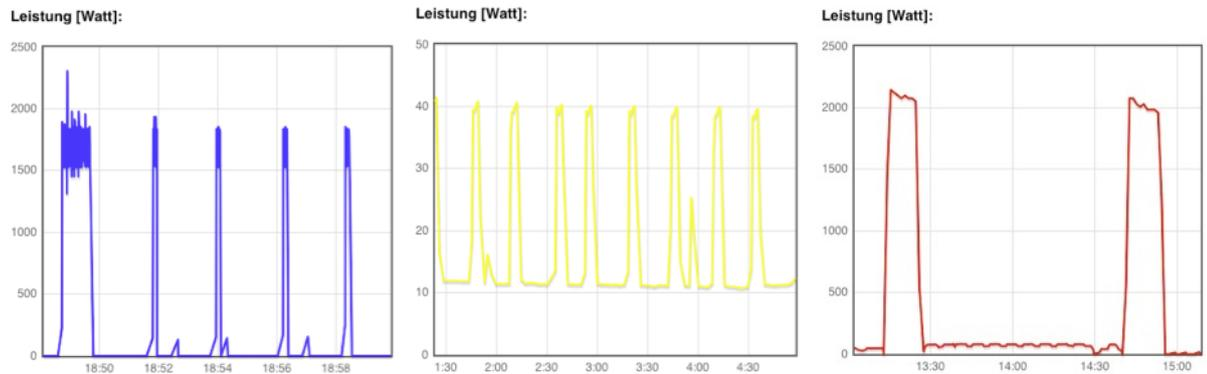
Tatsächlich birgt die verbraucherfreundliche Lösung einer automatischen und feingranularen Verbrauchserfassung durch den Stromzähler die Möglichkeit zur Erstellung eines präzisen Lastprofils. Der Lastgang eines Haushalts verrät viel über die Gewohnheiten der Personen, die in diesem Haushalt leben. Anhand der gemessenen Daten lassen sich Nutzungsprofile erstellen. Es sind im Prinzip Rückschlüsse auf die Lebensgewohnheiten des Haushaltes möglich:
